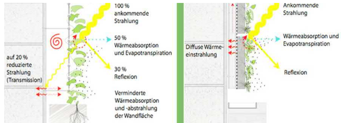
Wirkungsprinzip von Kletterpflanzen und Living Walls (Pfoser, 2012)
